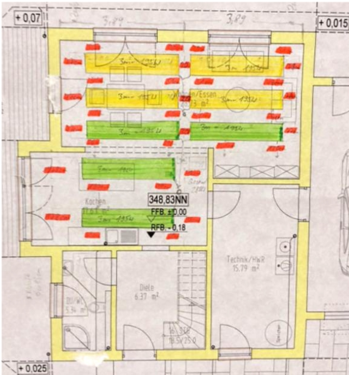
Plattegrond met getekende plafondverwarming.
